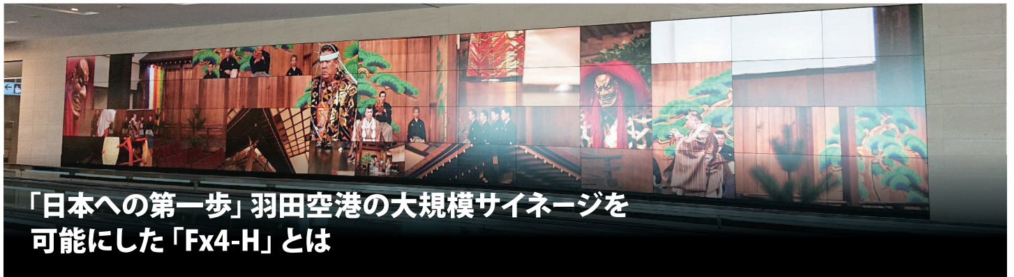
▲ 出発コンコースに設置した55インチ×64面のマルチサイネージ
